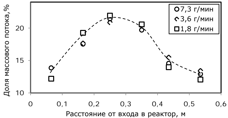
Рисунок 4.11 — Распределение плотности относительных массовых потоков на стенку реактора при синтезе нанопорошка оксида алюминия для различных расходов дисперсного сырья.
