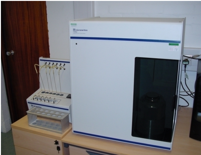
Рисунок 2.5 — Анализатор удельной поверхности Micrometrics TriStar 3000
