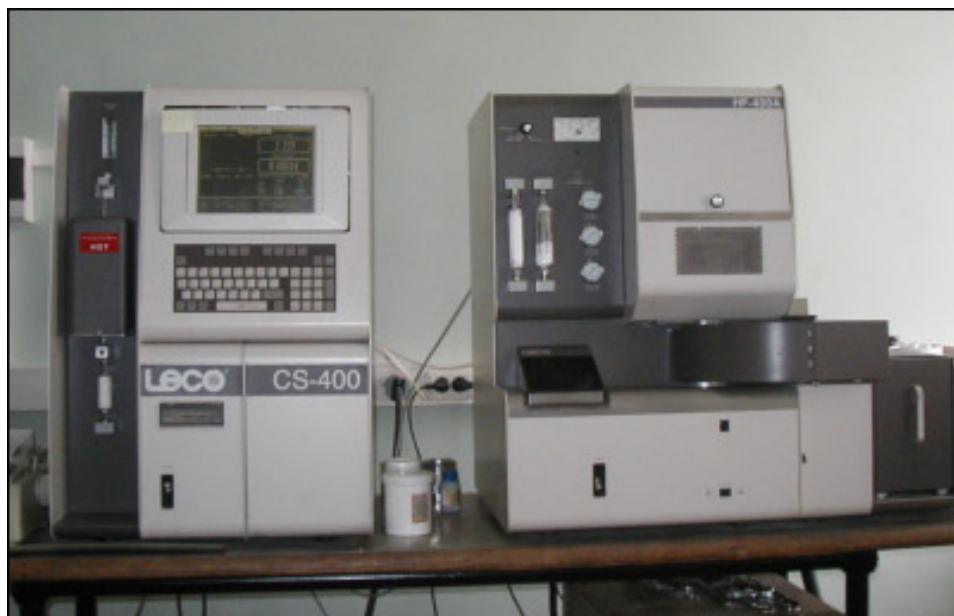
Рисунок 2.7 — газоанализатор LECO CS-400
