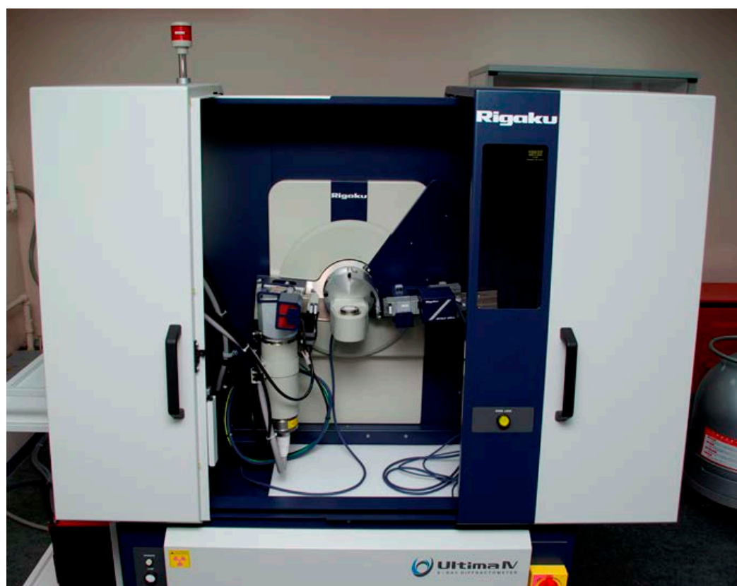
Рисунок 2.6 — Многофункциональный рентгеновский дифрактометр Rigaku Ultima IV
